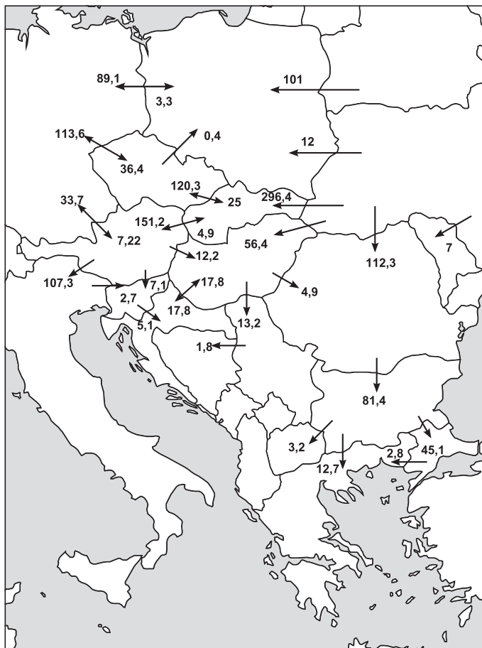
3. ÁBRA • Nemzetközi szállítóvezeték-hálózat a kiinduló referencia-forgatókönyvben (millió m 3 /nap)
